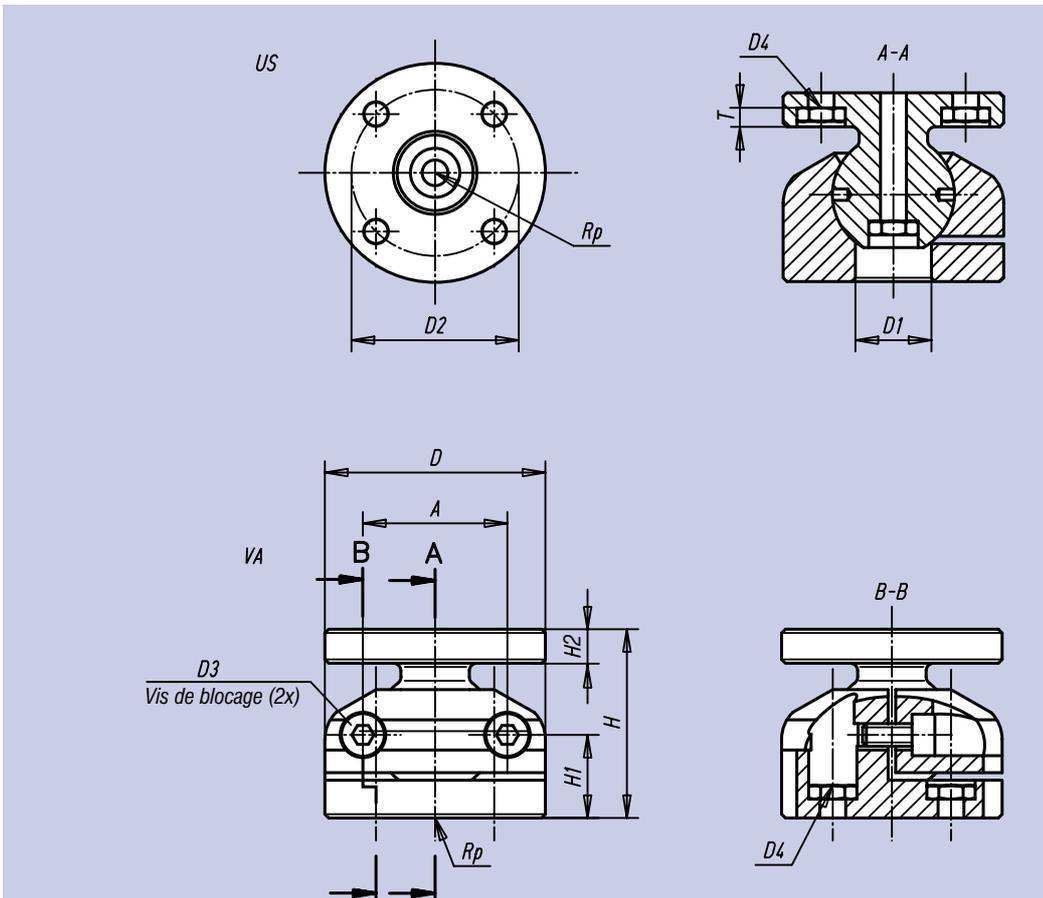
Les 9 lamages suivant DIN 74 sont équipés d'écrous inclus (D<sub>4</sub>)
