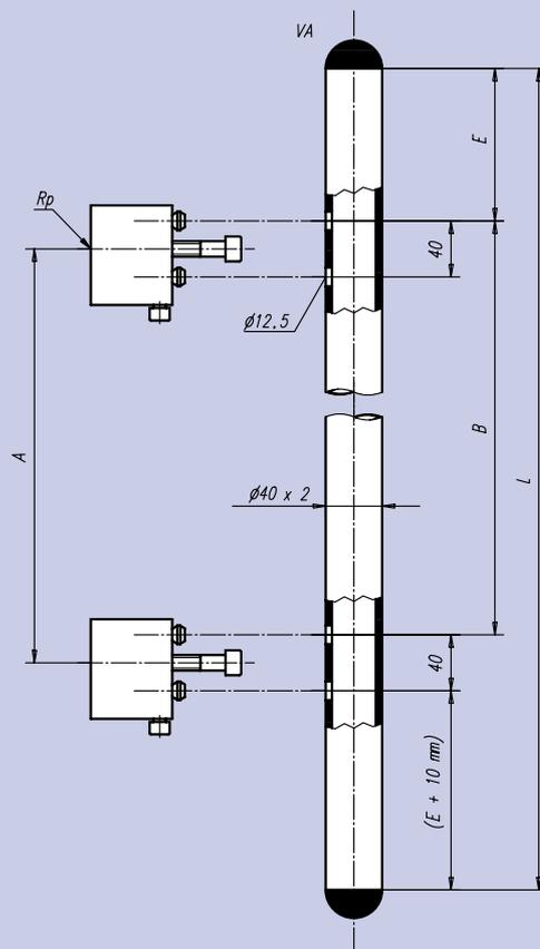
Schéma de serrage des supports:
