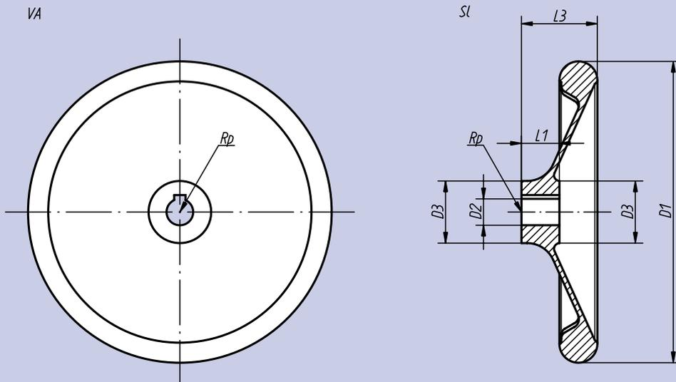
Rainure pour moyeu conformément à DIN 6885-1
