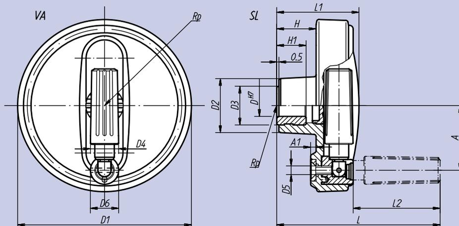
Rainure pour moyeu conformément à DIN 6885-1
