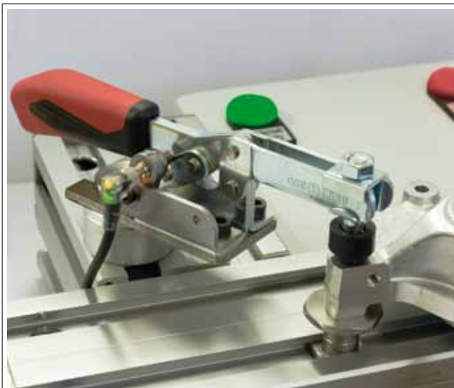
Horizontale spanner met sensorafvraging voor automatiseringen
