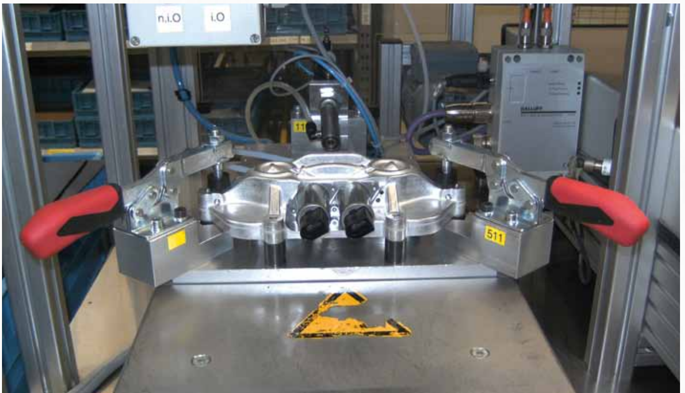
Horizontale spanner nr. 6830 voor het gebruik op een werkstukhouder voor de dichtheidstest. Hier wordt een component voor de nokkenfreesverstelling gespannen.
