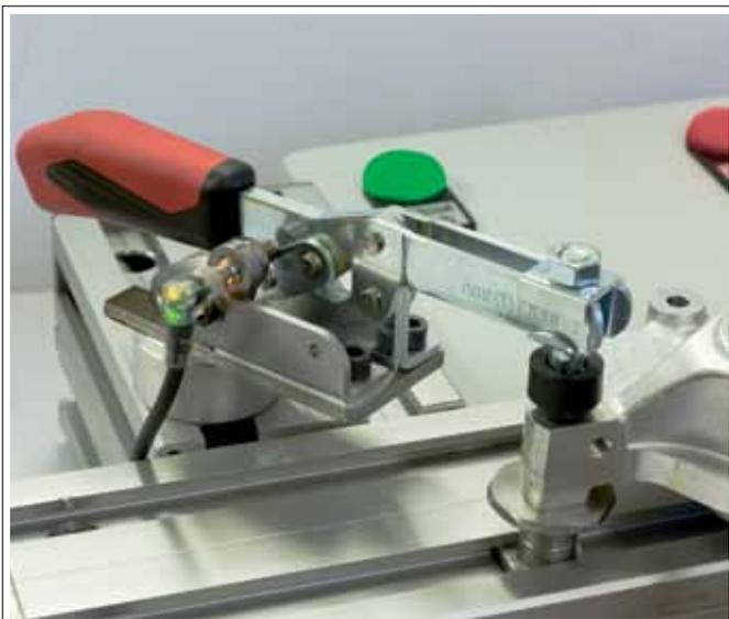
Waagrechtspanner mit Sensorabfrage für Automatisierungslösungen
