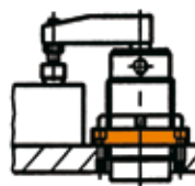
Avec bride filetée et écrou à encoches
